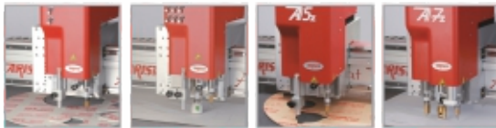
Multi Head IV, MHV, MH VA7z: Kesme, Titreşimli Kesim, Tam / Yarım Kesim, Ezme/Kırma, Delme, Markalama
